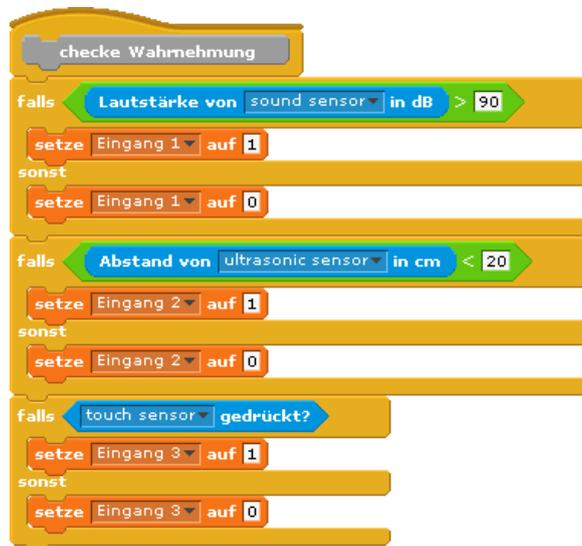
Abbildung 8 : Wahrnehmungen des Roboters
